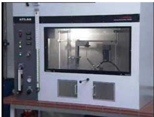
Рис.1. Установка для испытания материалов на пожаростойкость по UL94.
